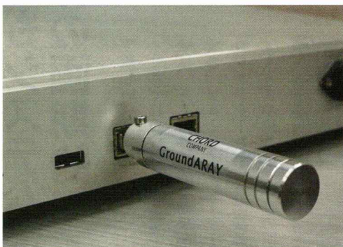
「グラウンドアレイ」は空き端子に差すだけ。振動、ノイズ対策のレベルは最高峰ケーブル「コードミュージック」と同等のものであるという
