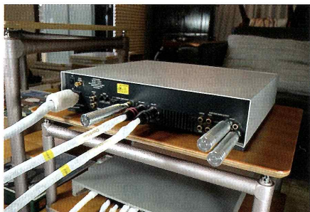
CDプレーヤーはデジタル出力(RCA)に1本と、アナログ出力にはL/R各1本ずつを差す
